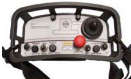
Detalle de mando de control por radio de las pulidoras
