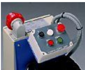
Configuración habitual de los controles en las pulidoras
