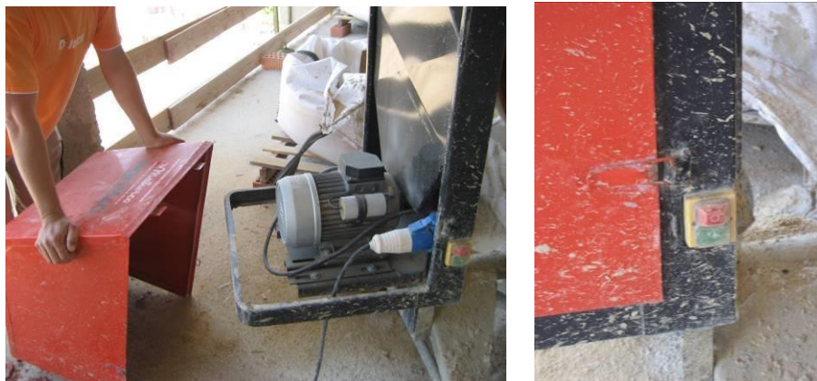
Ubicación de los controles de la hormigonera
