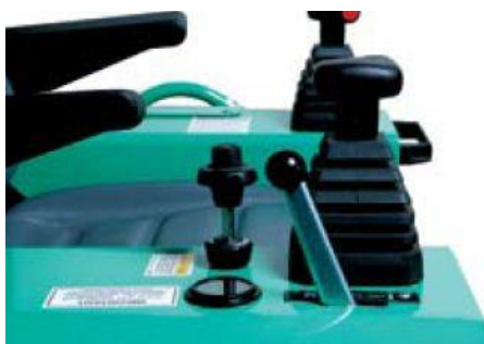
Nuevo diseño de los mandos de las fratasadoras dobles
