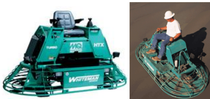
Fratasadoras dobles. Nuevos diseños de mandos y controles
