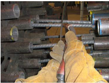
Imagen 44. Proceso correcto. Mano que sujeta la pistola nivel superior a la mano que sujeta el hilo.
