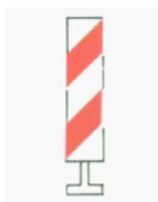
Imagen 11. Ejemplo de balizamiento reflectante, tipo TB
