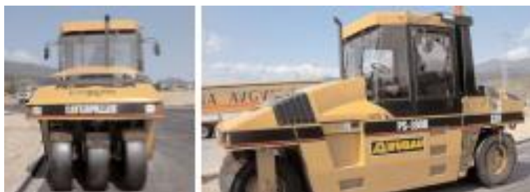
Imagen 17. Compactador de neumáticos.
