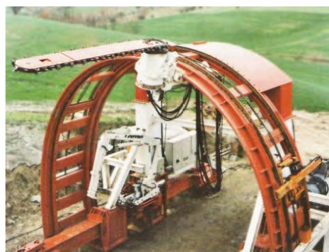
Imagen 10. Máquina de precorte mecánico. Utilizada en el túnel de Lunardi. Fuente: Capítulo 7. Métodos de excavación. Dirección general de servicios técnicos de México.
