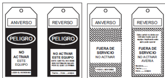
Ejemplos de carteles que pueden colocarse sobre los dispositivos de manobra para que no sean accionados.
