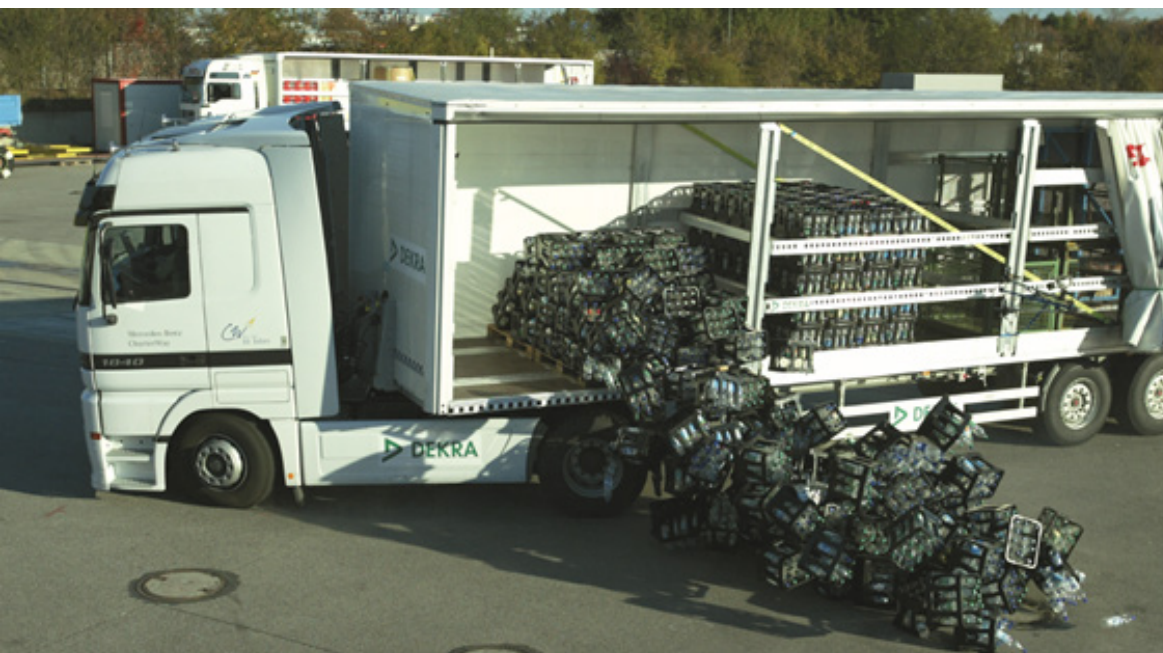
Figura 8 Ejemplo de pérdida de mercancía por estar suelta en la superficie de carga. Fuente: DEKRA.
