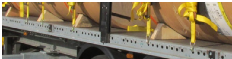
Figura 56 Vista de unas cuñas empleadas como bloqueo local. Fuente: DEKRA.
