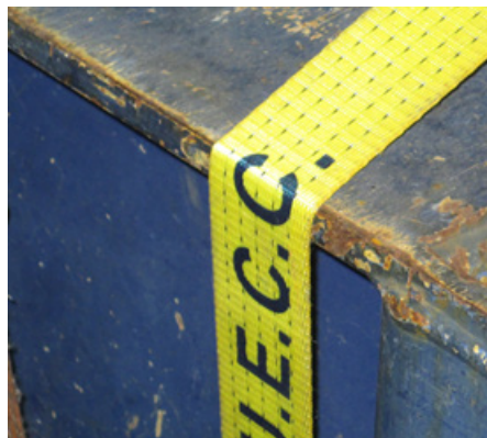
Figura 44. Cincha de amarre expuesta a desgaste por la esquina puntiaguda. Fuente: DEKRA.
