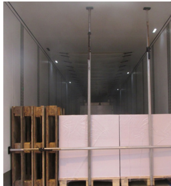
Figura 41 Conjunto de barras verticales y horizontales telescópicas empleadas en cajas cerradas de transporte. Fuente: DEKRA.
