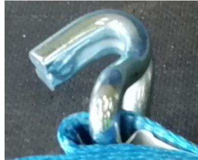
Figura 21 Imagen de un gancho cerrado. Fuente: DEKRA
