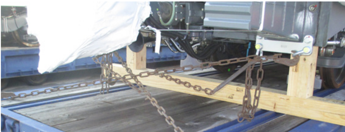
Figura 34 Vista de una configuración de cadenas de amarre. Fuente: DEKRA.
