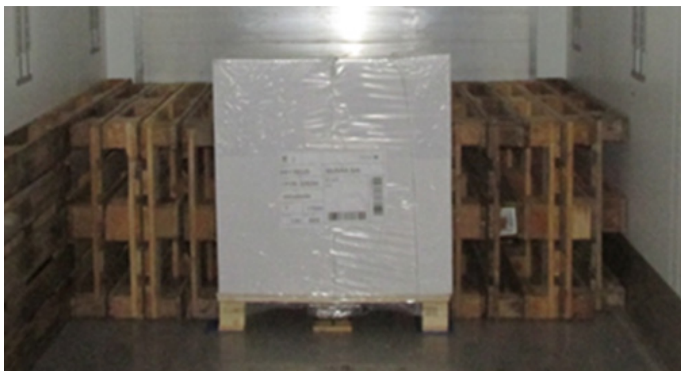
Figura 51 Empleo de palés como relleno para impedir el movimiento de la carga. Fuente: DEKRA.
