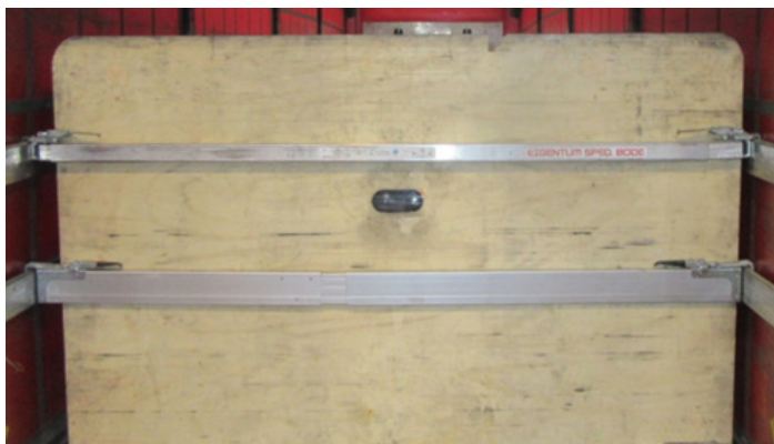
Figura 54 Bloque local empleando una pared del vehículo. Fuente: DEKRA.
