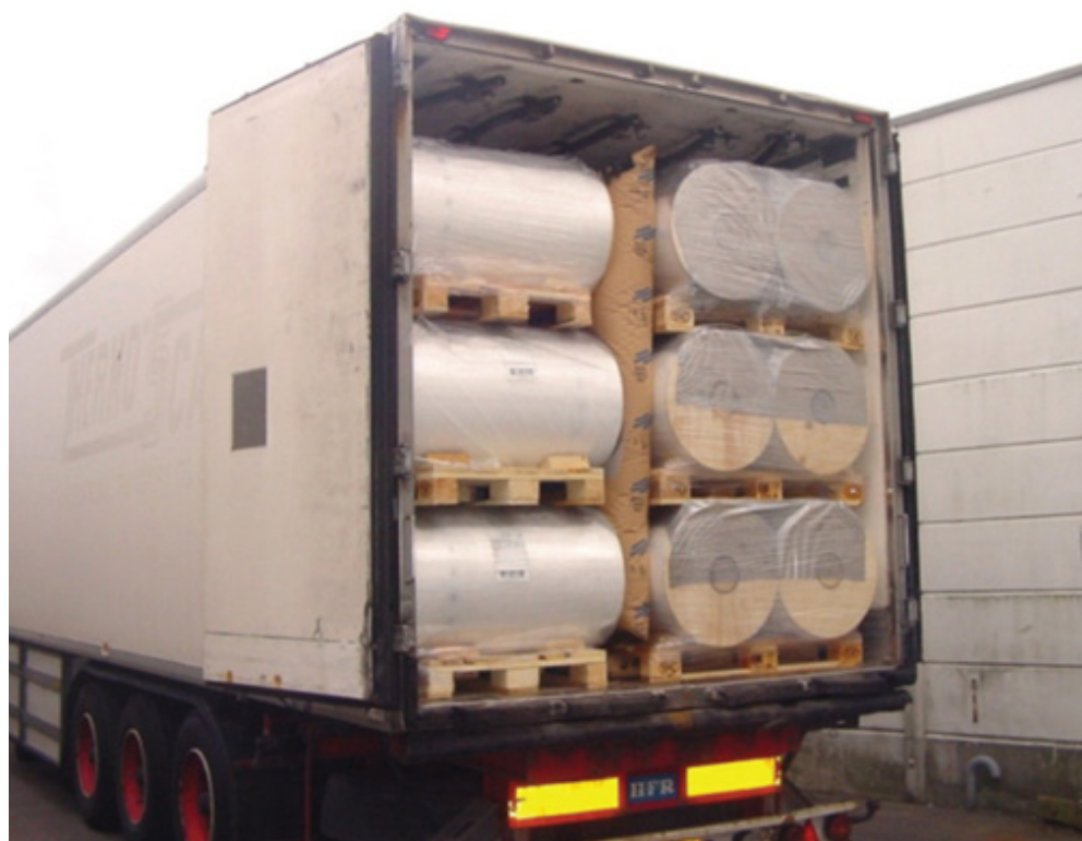
Figura 50 Vista de un relleno del tipo airbag colocado entre palés con rollos de papel para impedir el movimiento de las cargas. Fuente: DEKRA.
