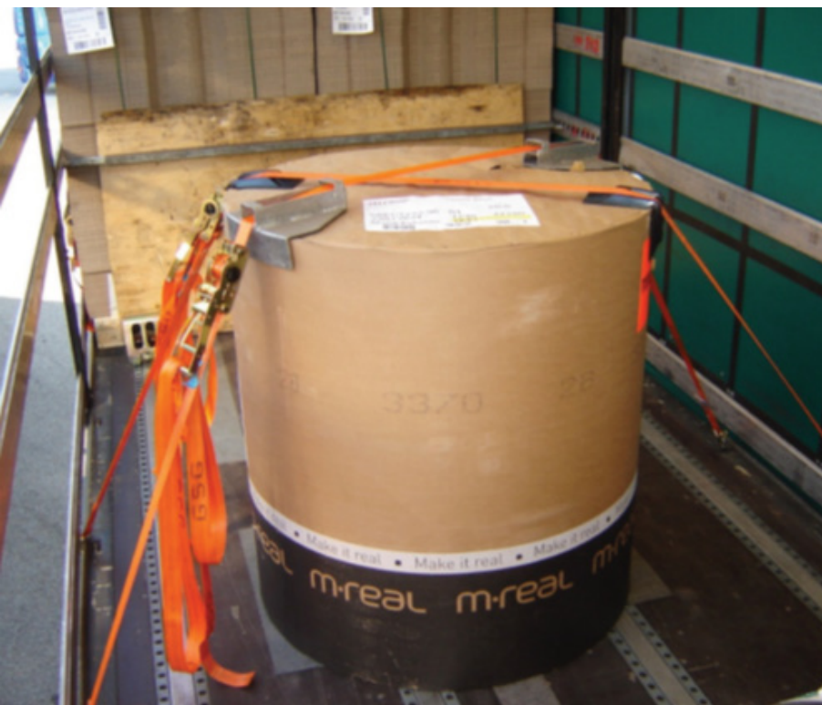
Figura 43. Vista de las cantoneras, en la parte superior de la carga, para la protección de las cinchas de amarre y la mercancía. Fuente: Guía europea de mejores prácticas sobre sujeción de cargas para el transporte de carreteras 2014 .
