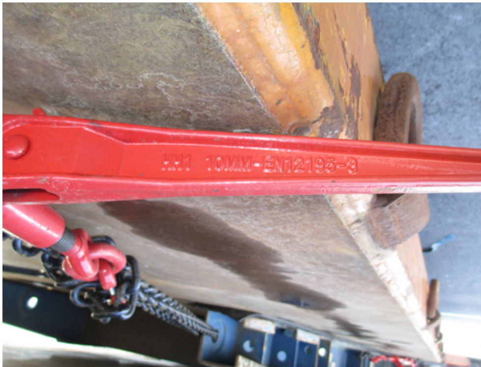
Figura 35 Vista de un tensor de cadena de amarre. Fuente: DEKRA.
