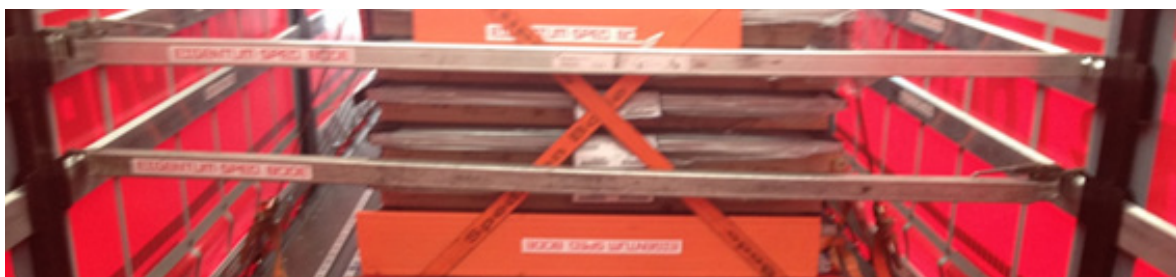
Figura 40 Barras de bloqueo horizontales. Fuente: DEKRA.
