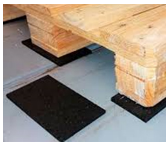
Figura 38 Empleo de alfombras o gomas antideslizantes para evitar desplazamientos de la carga. Fuente: DEKRA.
