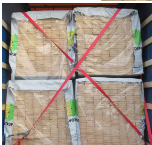
Figura 65 Empleo de dos eslingas para hacer una amarre don resorte cruzad. Fuente: DEKRA.
