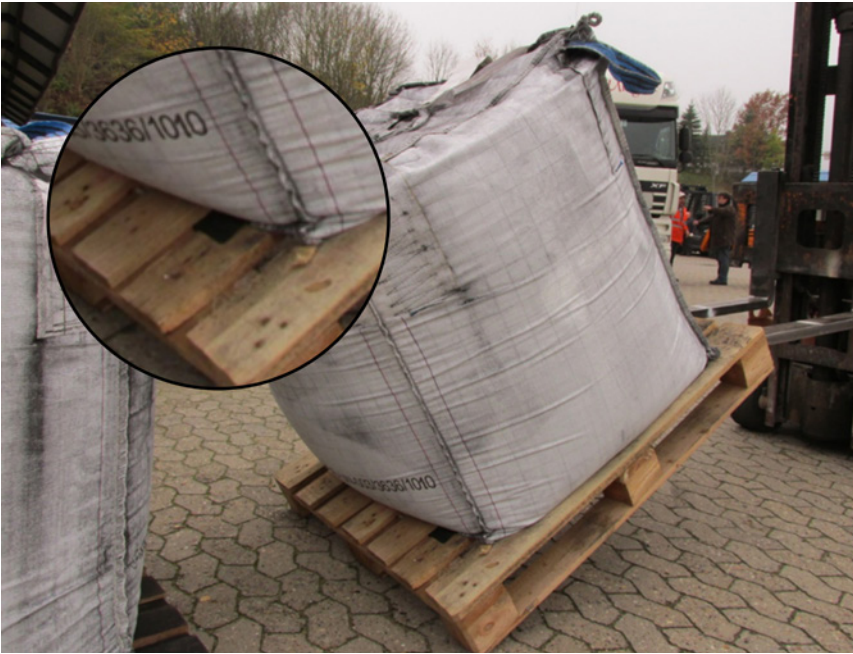
Figura 39 Ensayo de resistencia al deslizamiento de un saco industrial (tipo big-bag) sobre un palé con alfombra antideslizante colocada entre ambos (ver detalle). Fuente: DEKRA.
