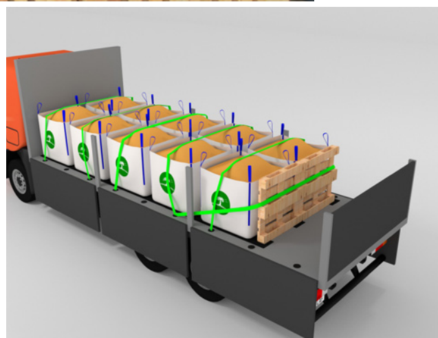
Figura 63 Otro ejemplo de Amarre con resorte empleando palés.
