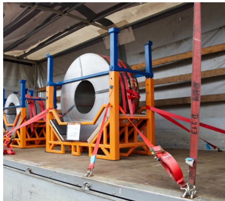
Figura 56 Vista de unas cuñas empleadas como bloqueo local. Fuente: DEKRA.
