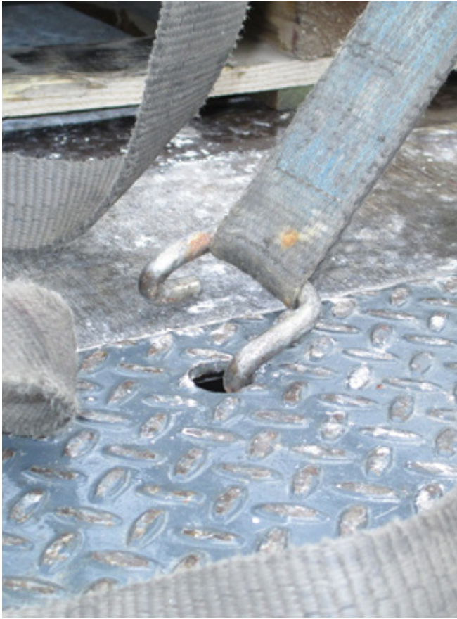
Figura 20 Mala utilización de un equipo de sujeción (gancho abierto). Fuente: DEKRA
