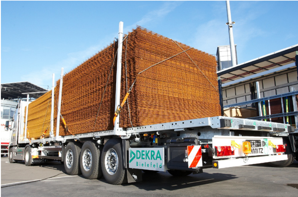
Figura 33 Otra configuración de amarre con cables de acero y cintas. Fuente: DEKRA.
