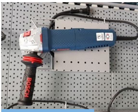
Radial dotada de empuñadura antivibratoria.
