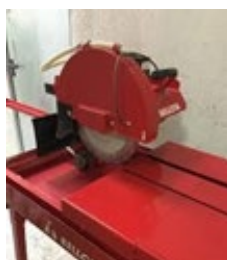
Equipo de trabajo: Mesa de corte cerámica Aceleración m/s^2 : 3-5 m/s^2
