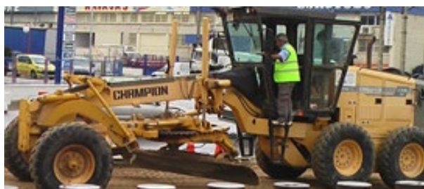
Equipo de trabajo: Motoniveladora Aceleración m/s^2 : 0.2-0.8
