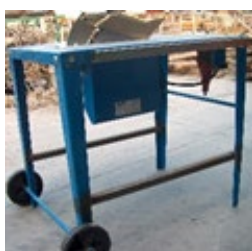
Equipo de trabajo: Mesa de corte madera Aceleración m/s^2 : 2.5-5 m/s^2
