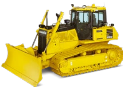
Equipo de trabajo: Bulldozer Aceleración m/s^2 : 0.2-1 m/s^2
