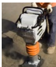
Equipo de trabajo: Pisón compactador Aceleración m/s^2 : 10-20 m/s^2
