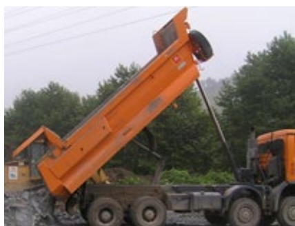
Equipo de trabajo: Camión basculante Aceleración m/s^2 : 0.4-0.8 m/s^2
