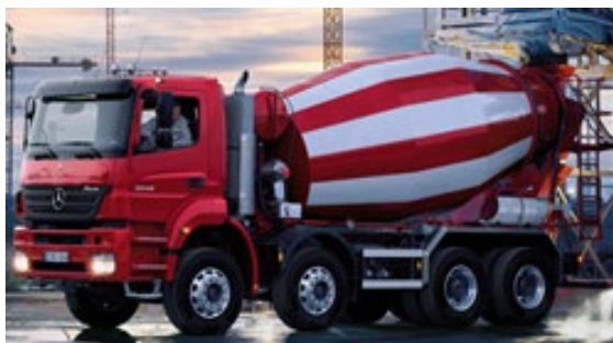
Equipo de trabajo: Camión hormigonera Aceleración m/s^2 : 0.5-0.9 m/s^2
