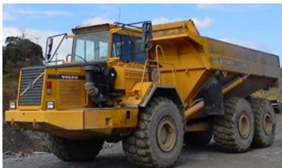
Equipo de trabajo: Dumper Aceleración m/s^2 : 0.5-1.2 m/s^2
