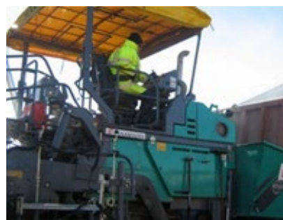
Equipo de trabajo: Extendedora Aceleración m/s^2 : 0.1-0.4 m/s^2
