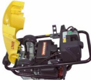
Carcasa de protección de elementos de control
